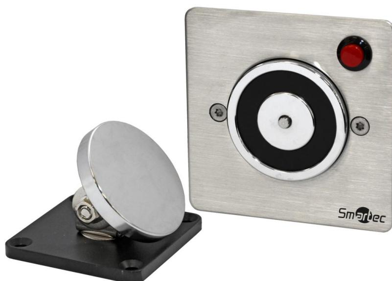
Электромагнитный фиксатор дверей ST-DH603U предназначен для удерживания дверей в открытом положении. Устройство используется в случаях, когда необходимо обеспечить свободное перемещение людей и техники. Кроме того, электромагнитный фиксатор можно подключить к системе пожарной сигнализации, и в случае возникновения пожара на объекте устройство разблокирует удерживаемую дверь и обеспечит герметизацию зоны. Кнопка отключения фиксации может использоваться для разблокировки двери вручную.
